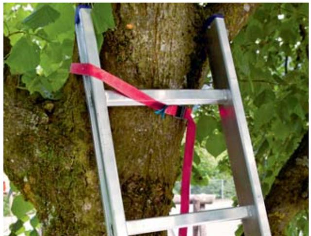
Fig. 28: sécurisation au moyen de sangles d'arrimage
