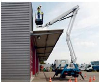
Fig. 7: plate-forme élévatrice mobile de personnel multidirectionnelle non automatisée
